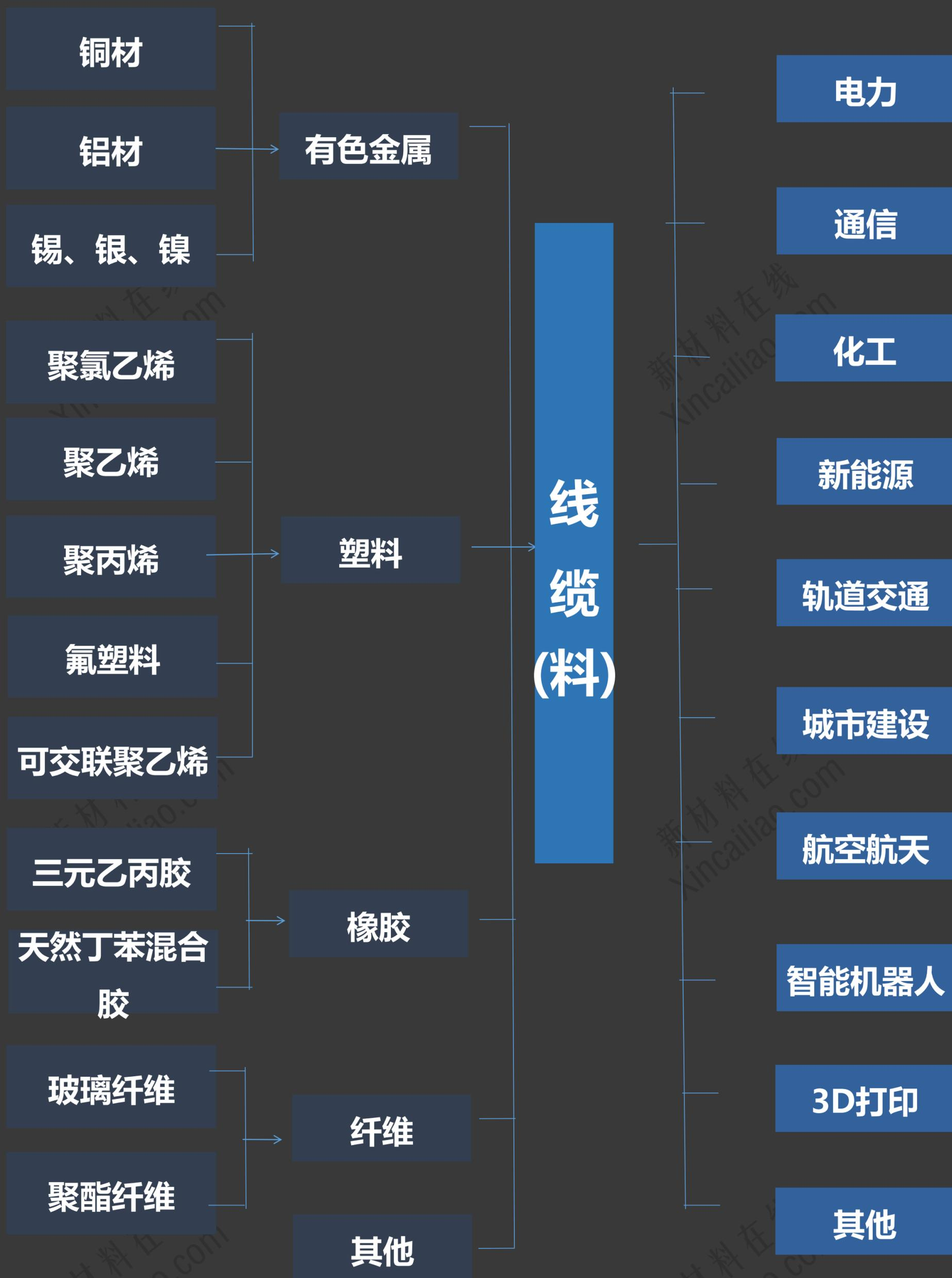
电线电缆的主要用途是电力传输、电气通信和绕制电气装备用的线圈或绕组。
