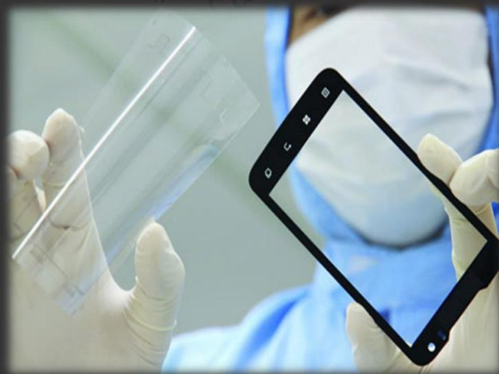
纳米银线制备的透明导电膜
